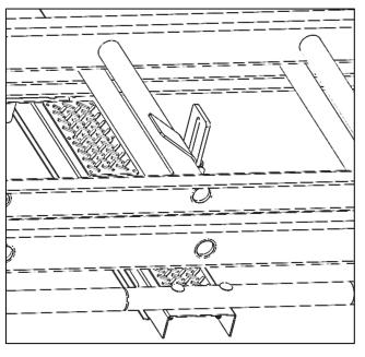
BE SURE THE LADDER HOOKS ARE FIRMLY AGAINST THE LADDER STEPS OR RUNGS.
