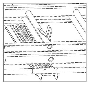
BE SURE THE LADDER HOOKS ARE FIRMLY AGAINST THE LADDER STEPS OR RUNGS.
