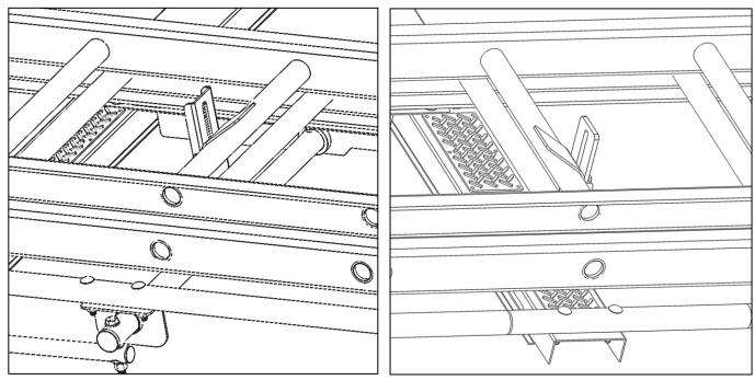
\*\* BE SURE THE LADDER HOOKS ARE FIRMLY AGAINST THE LADDER STEPS OR RUNGS. \*\*
